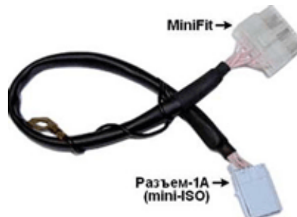
Рис.2.1. Переходник MiniFit-VAG (8pin)
