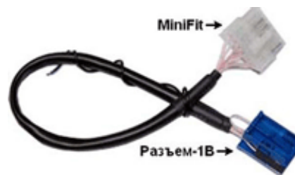
Рис.2.2. Переходник MiniFit-VAG (12pin)
