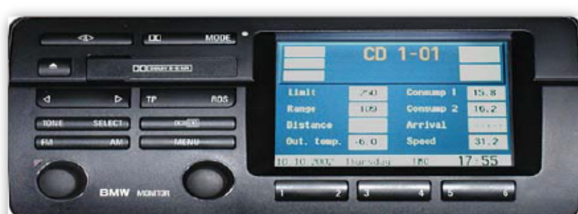
Штатная магнитола для BMW Monitor 4:3 (адаптер можно подключить только в багажнике (к разъему питания радиоблока или проводке))
