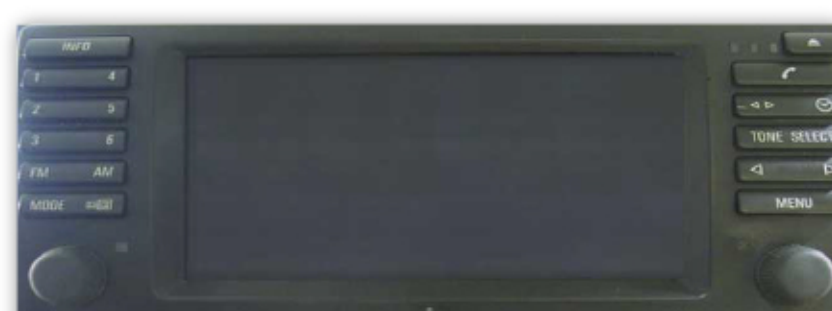
Штатная магнитола для BMW Monitor 16:9 (адаптер можно подключить только в багажнике (к разъему питания радиоблока или проводке CD-чейнджера))
