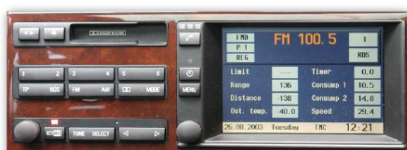
Штатная магнитола для BMW Autoradio 4:3 (адаптер можно подключить только в багажнике (к разъему питания радиоблока или проводке CD-чейнджера))
